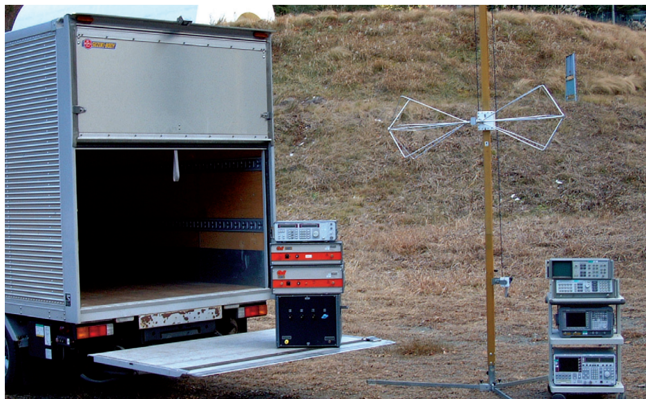
パイコニカルアンテナ他、測定装置
