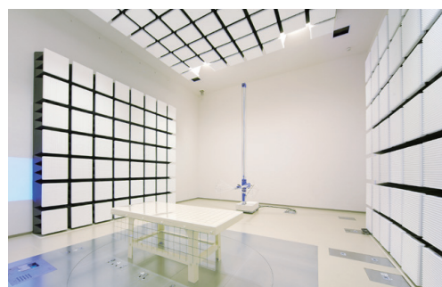
電波暗室内部
