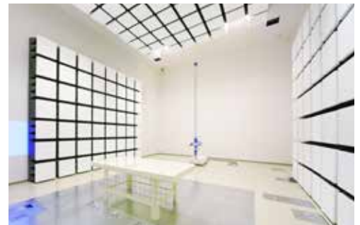
電波暗室内部
