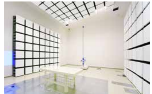
電波暗室内部
