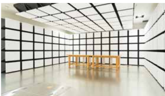
電波暗室内部
