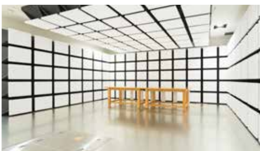
電波暗室内部
