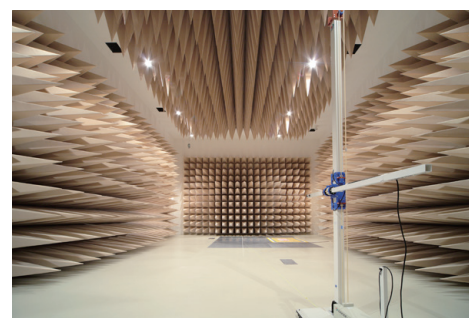
10m法電波暗室内部
